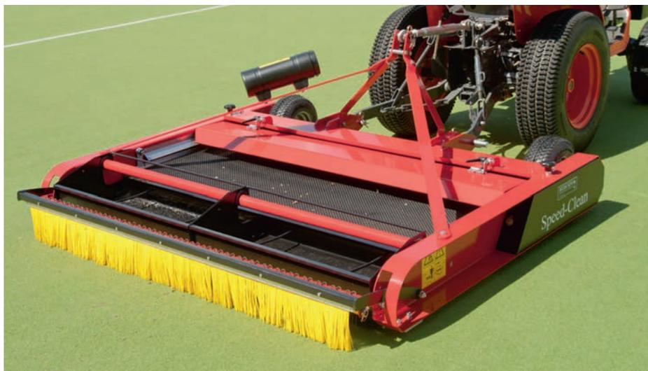
**VERTI-CLEAN** Le Verti-Clean collecte les débris de surface avec une brosse rotative qui les projette sur un tamis vibrant. Le tamis filtre les granulats pour les déverser sur la surface de jeu, tout en retenant les débris. La brosse rotative et le tamis vibrant sont actionnés par le mouvement de la machine.
